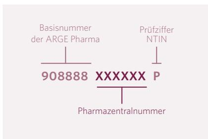
**Abbildung 4:** Aufbau der NTIN basierend auf der Pharmazentralnummer
